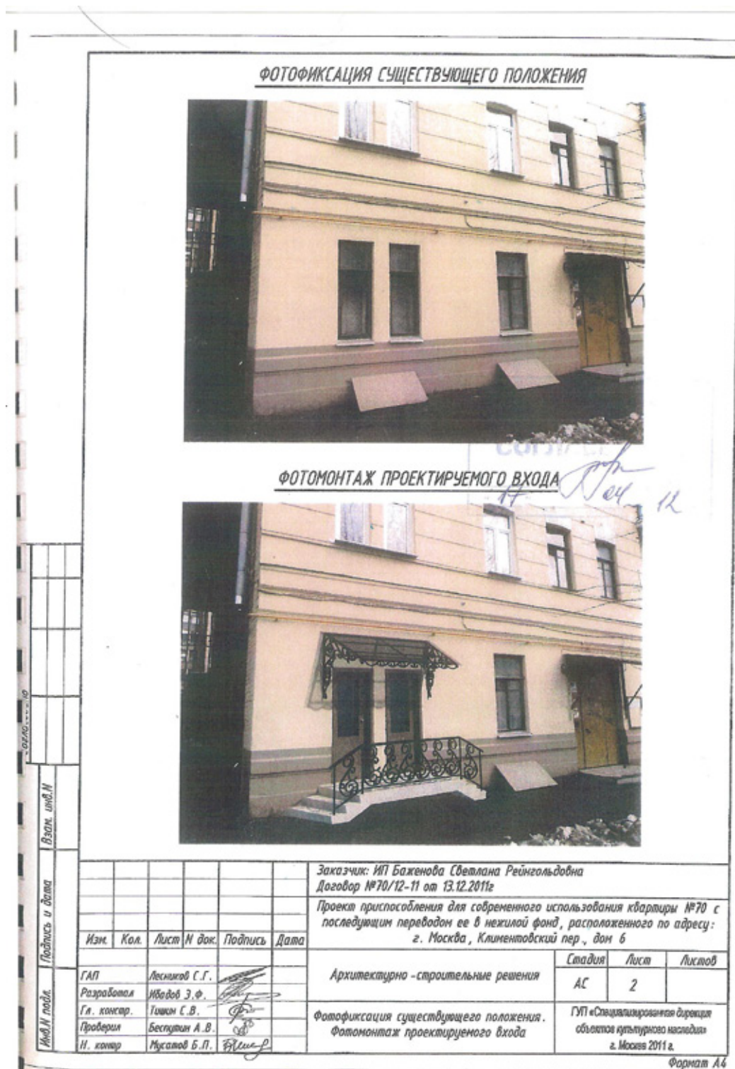
Рис. 3. Проект отдельного входа в офис, расположенный в квартире на первом этаже дома, показанного на Рис. 2
