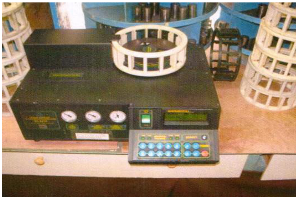
Рис. 1. Прибор неразрушающего контроля КС-221А
