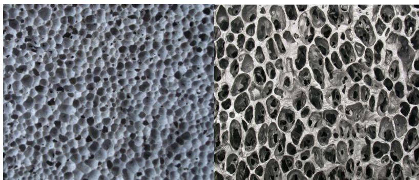
Рис. 1. Пеностекло с замкнутыми (слева) и сообщающимися (справа) порами
