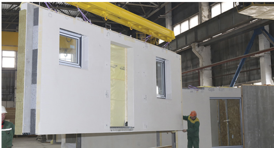
Рис. 1. Изготовление стеновой панели в заводских условиях строительной компанией «ТАМАК»
