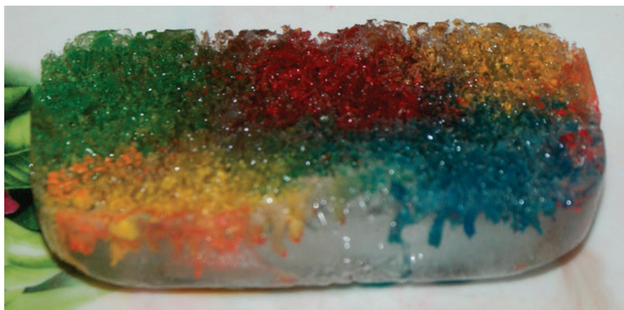
Рис. 5. Результат воздействия соли на лед
