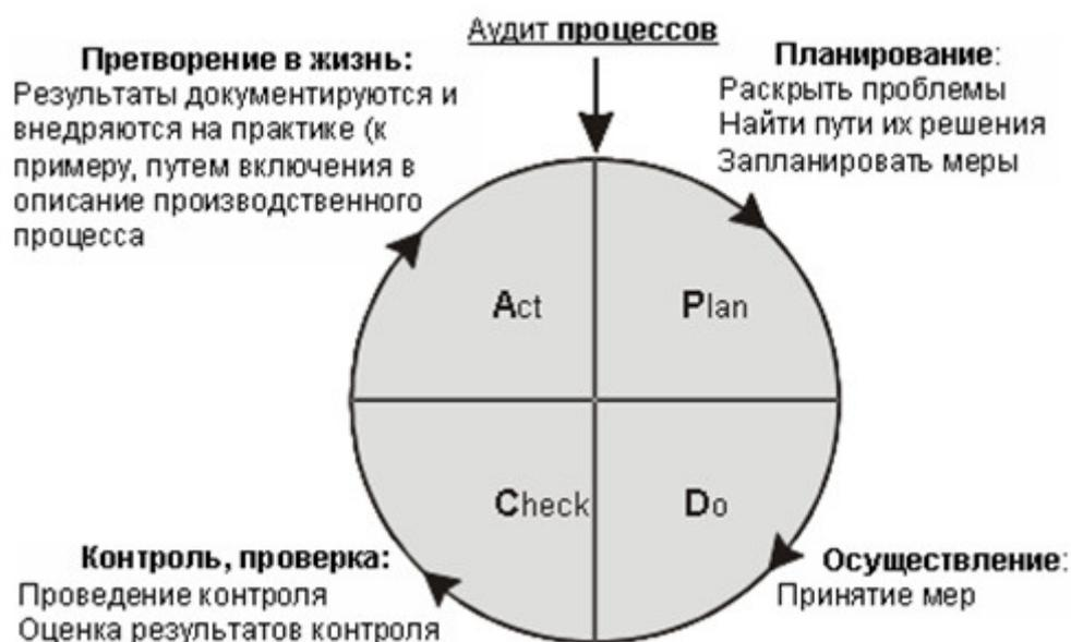
Рис. 1. Схема качества (Цикл Деминга)
