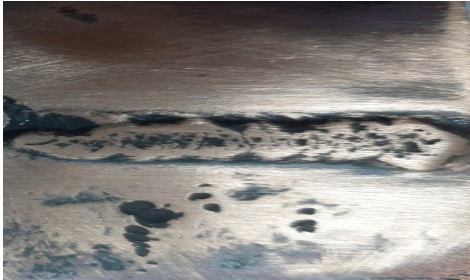
Рис. 4. Внешний вид обратной стороны сварного шва пластин меди толщиной 4,0 мм
