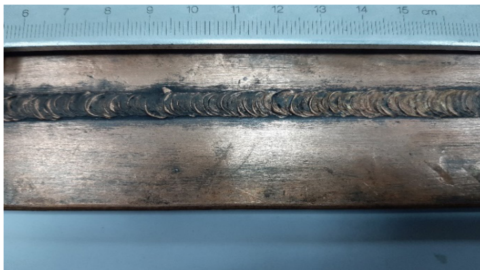
Рис. 4. Внешний вид лицевой стороны сварного шва пластин меди толщиной 4,0 мм
