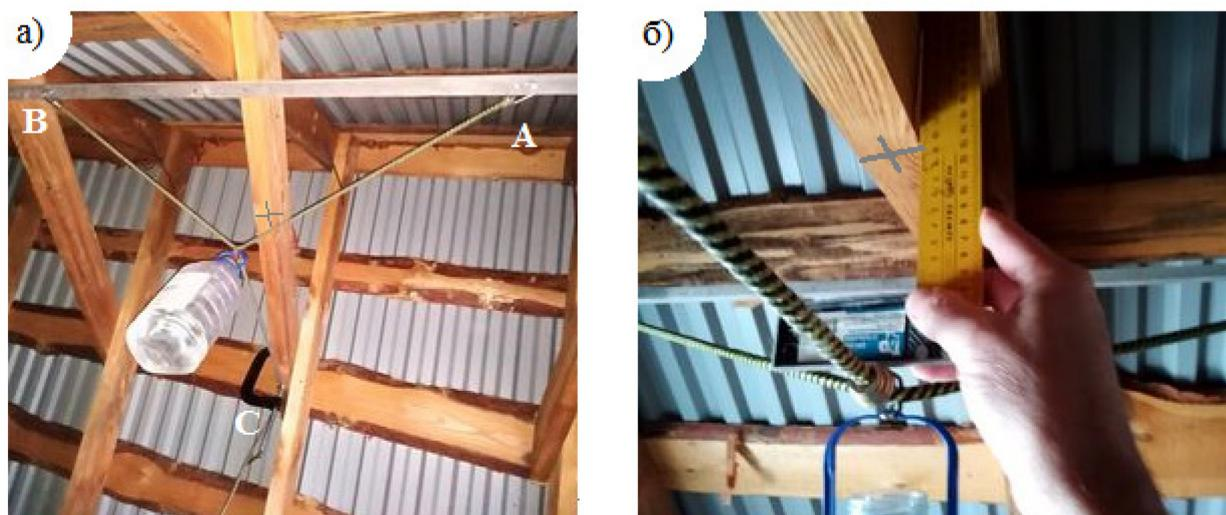
Рис. 4. Испытание Y-образной упругой системы: а) общий вид; б) измерение провиса
