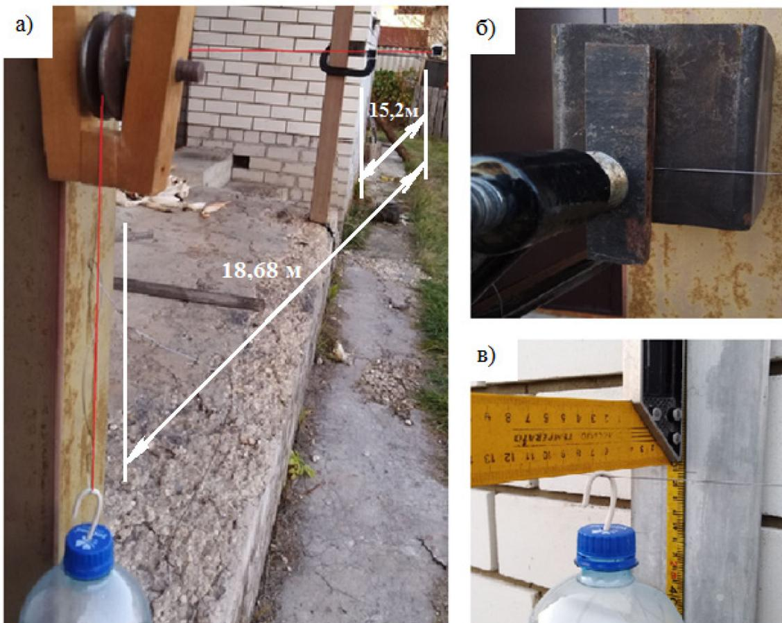
Рис. 6. Испытание стальной проволоки: а) общий вид; б) зажим; в) измерение провиса
