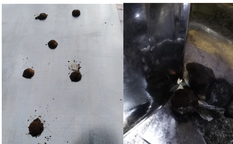
Рис. 3. Примёрзшие загрязнения на листе и в бункере после отчистки
