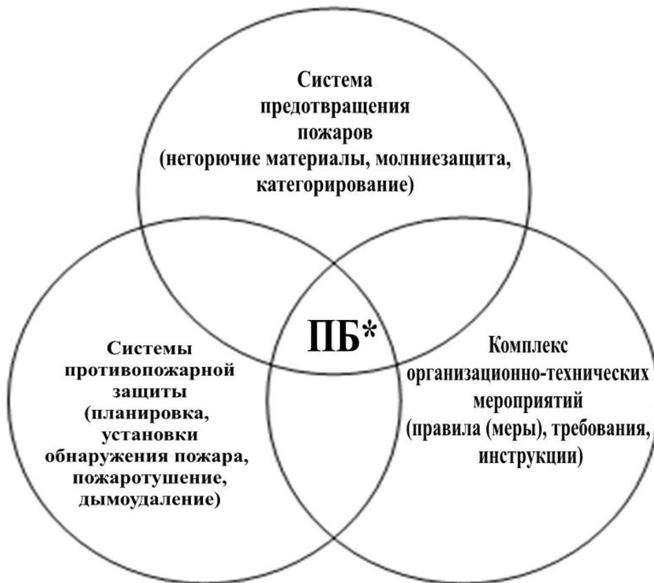
Рис. 1. Структура системы обеспечения пожарной безопасности объекта (\* пожарная безопасность)
