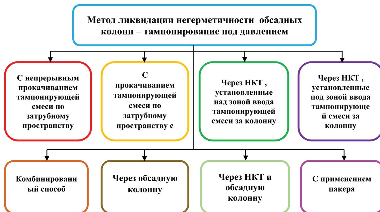
Рис. 2. Разновидности основного метода ликвидации негерметичности обсадных колонн и заколонного пространства — тампонирующее под давлением
