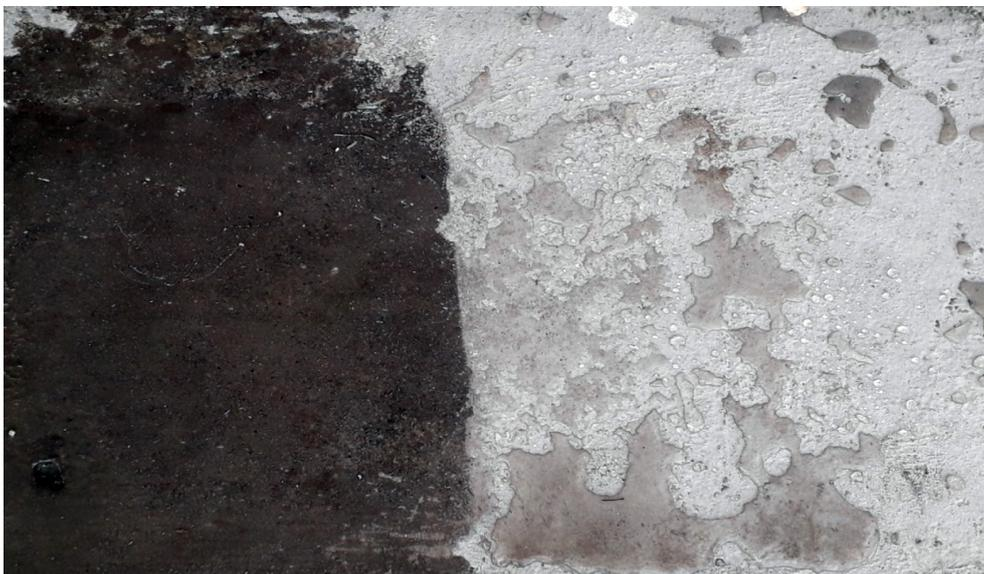
Рис. 7. Вода не проникает на обработанном участке
