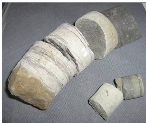
Рис. 1. Образец керна после испытания в морозильной камере через 20 циклов
