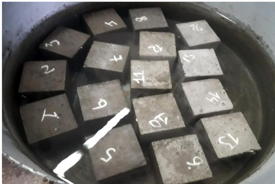
Рис. 8. Определение морозостойкости обработанных и необработанных образцов бетона
