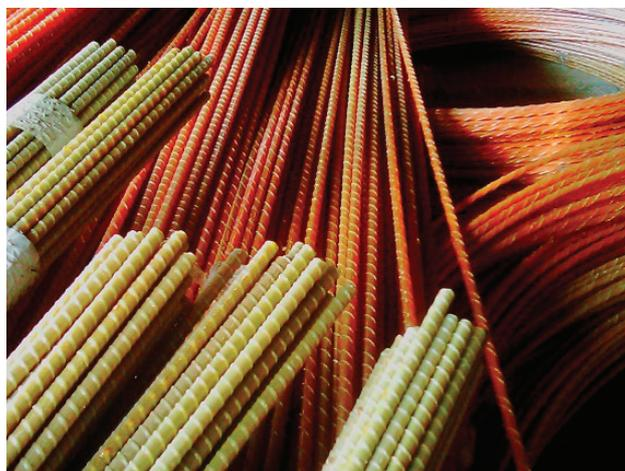
Рис. 1. Композитная арматура
