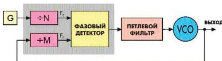
Рис. 1. Синтезатор PLL [1]
