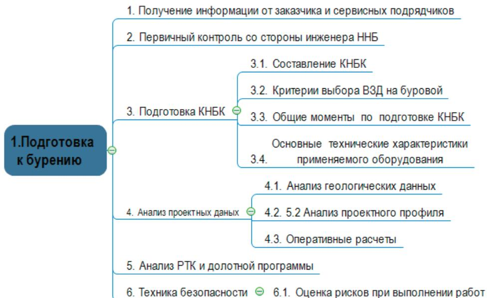
Рис. 2. Последовательность подготовки к бурению скважины
