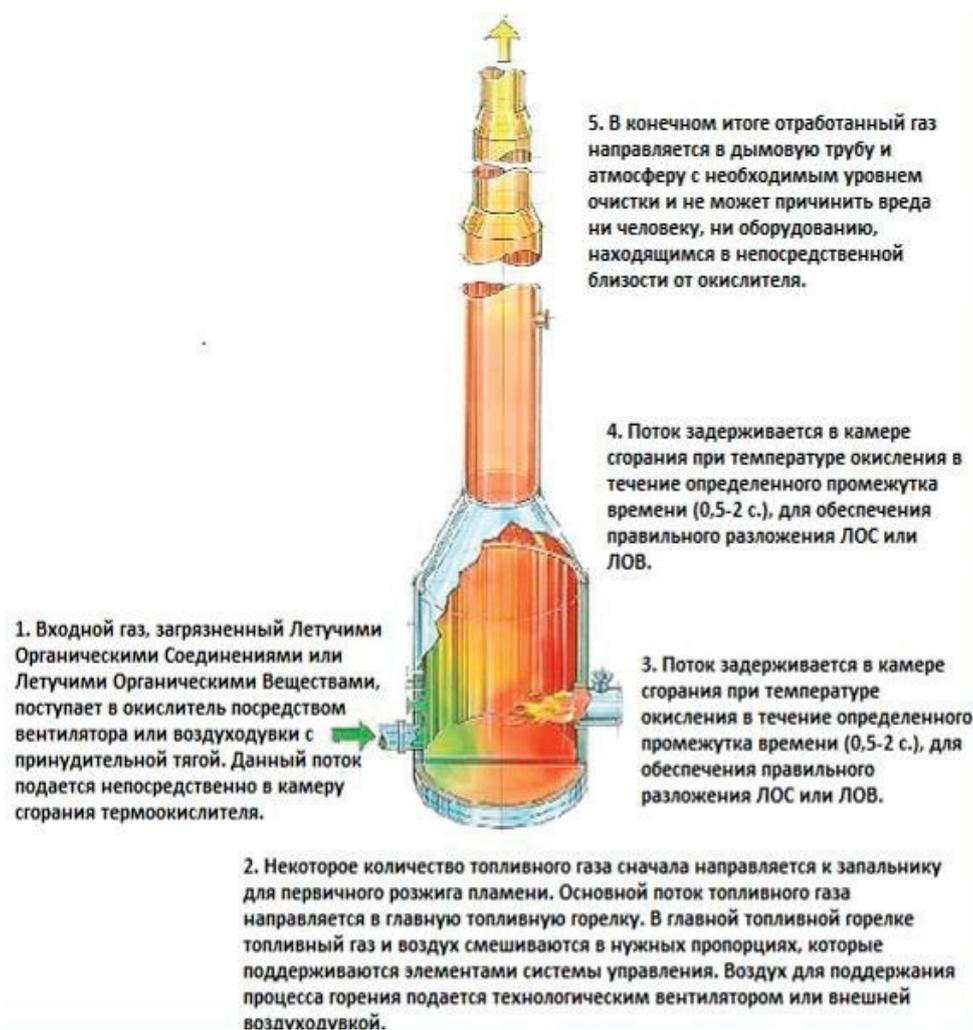
Рис. 2. Термоокислитель прямого сжигания [6]
