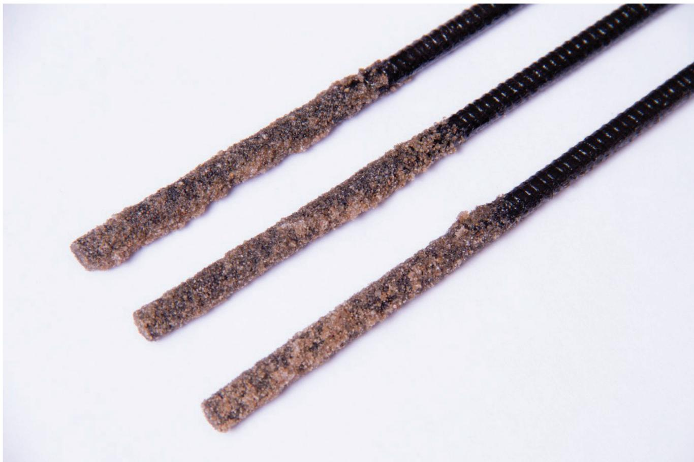
Рис. 2. Базальтопластиковые стержни с песчаным наконечником
