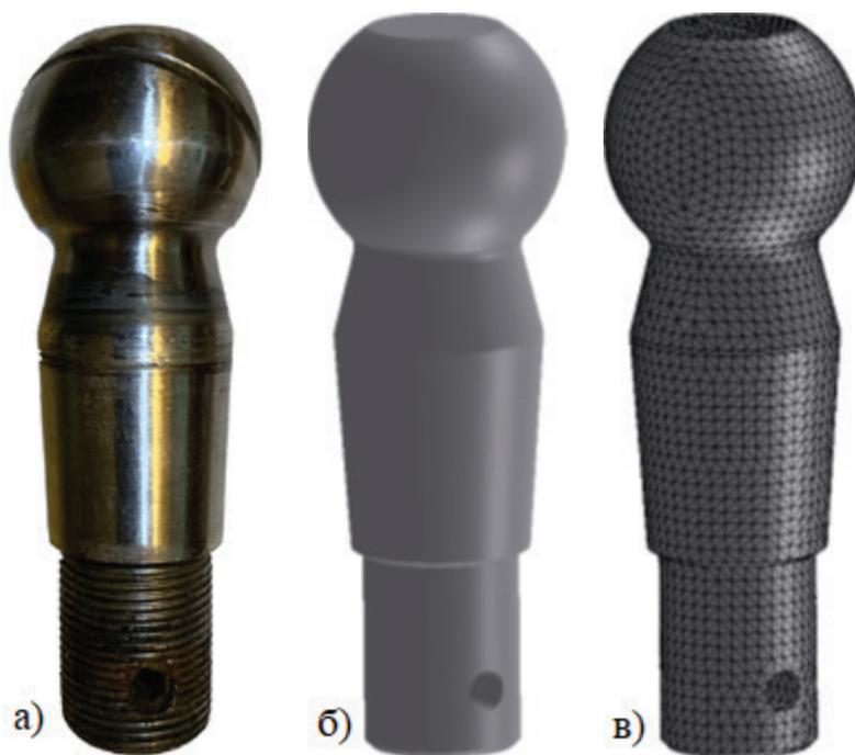
Рис. 2. а) Внешний вид пальца; б) Твердотельная модель; в) Конечно-элементная модель
