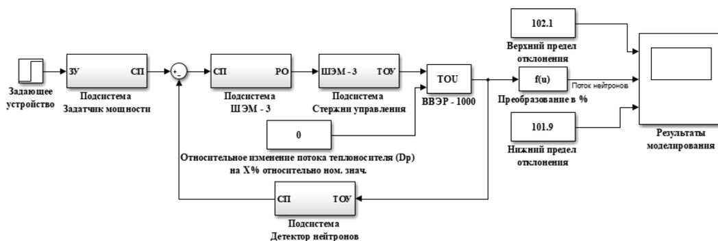
Рис. 1. Математическая модель САР ядерного реактора
