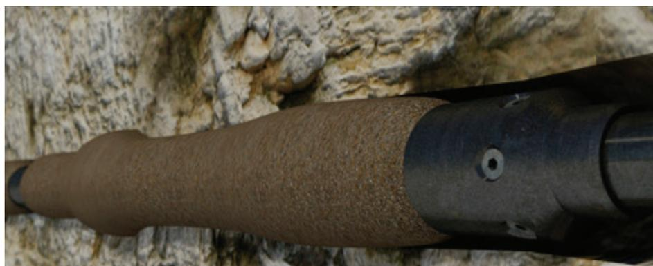
Рис. 7. Расширение в скважине полимера
