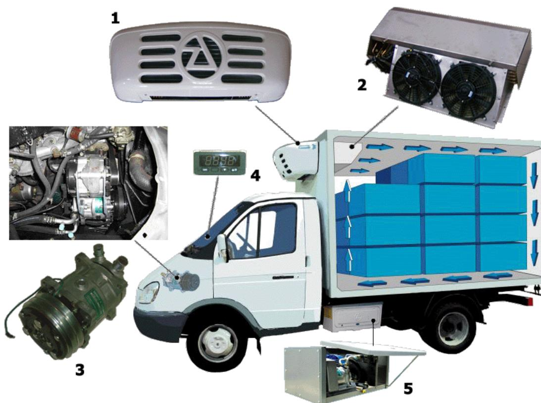
Рис. 3. Строение автомобильного рефрижератора
