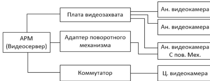
Рис. 1. Структурная схема УМКСВ
