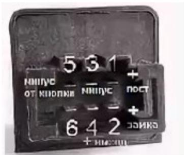
Рис. 1. Внешний вид импульсного реле 23.3777
