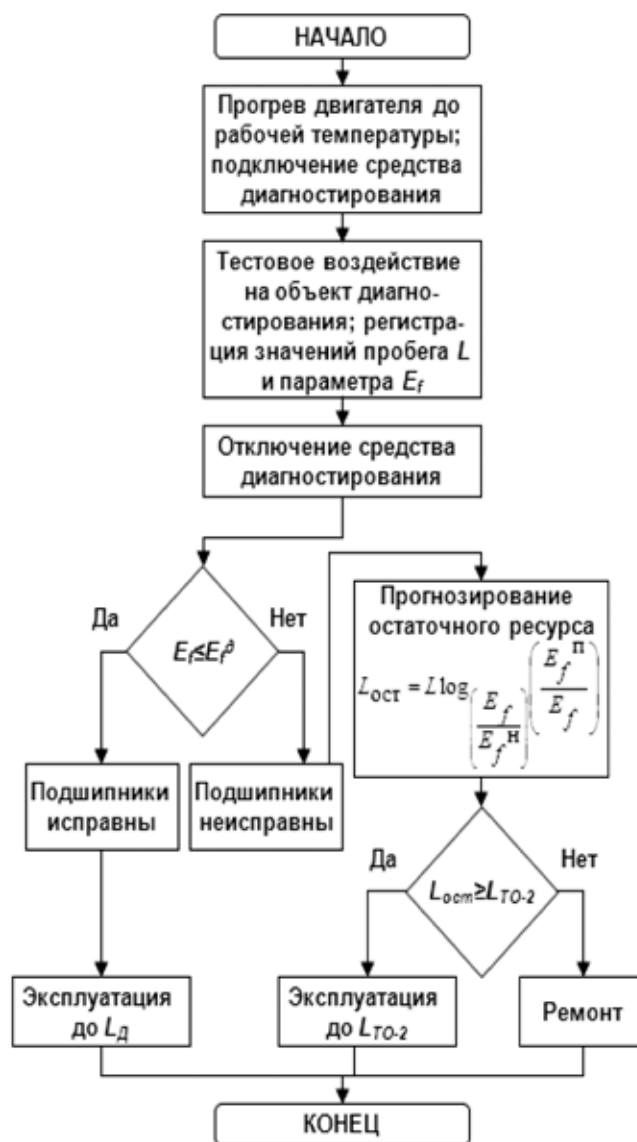
Рис. 7. Алгоритм диагностирования подшипников коленчатого вала
