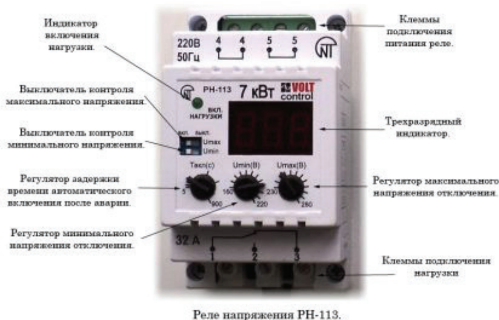
Рис. 1. Реле напряжения на микропроцессорной базе [2]
