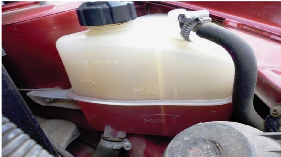
Рис. 2. Уровень жидкости в расширительном бачке: MAX и MIN
