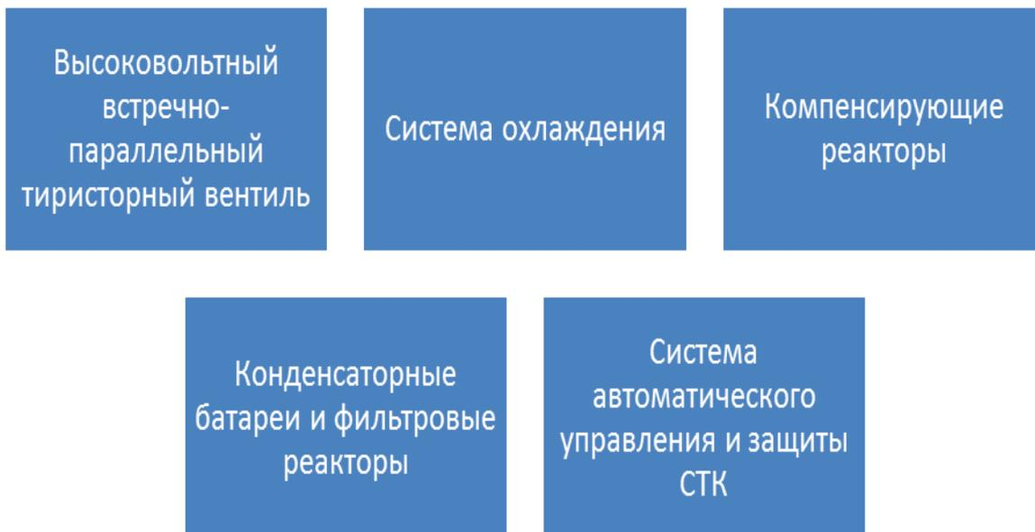
Рис. 1. Состав системы тиристорной компенсации реактивной мощности
