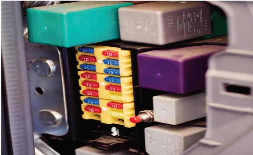
Рис. 1. Совокупность предохранителей антиблокировочной системы
