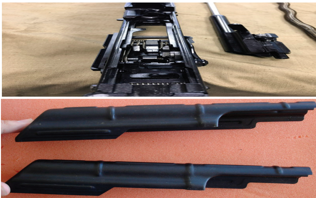
Рис. 2. Ствольная коробка и съемная крышка
