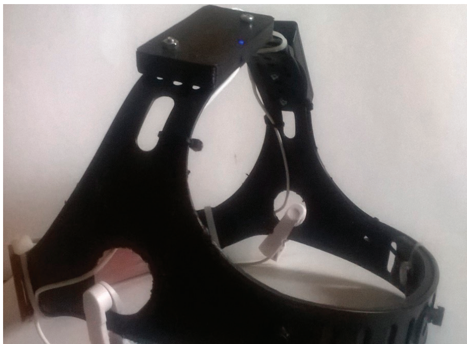
Рис. 2. ИМК в сборе и включен, о чем сигнализирует синий светодиод-индикатор на модуле блютуз BT04-A
