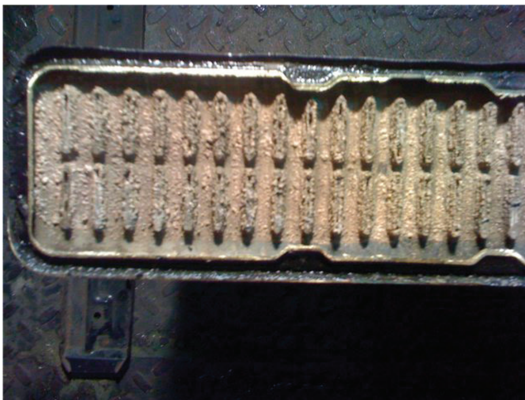
Рис. 3. Образование накипи внутри радиатора
