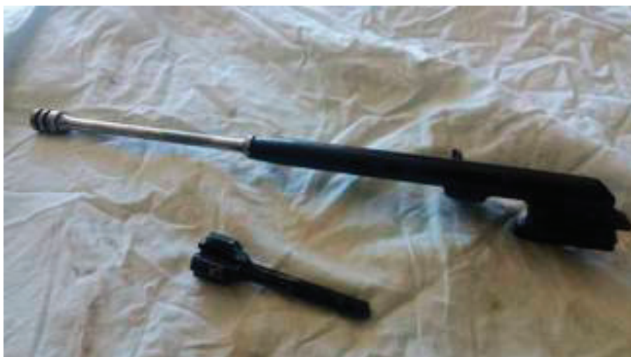
Рис. 3. Затворная группа: затворная рама с газовым поршнем и выбрасыватель с ударником
