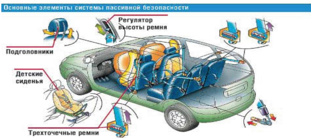
Рис. 2. Пассивная безопасность
