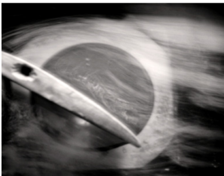
Рис. 9. Экспериментальное обтекание профиля с большим углом атаки
