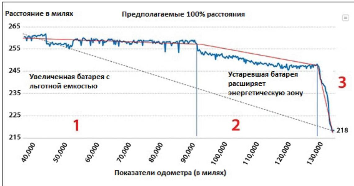
Рис. 2: Дальность движения электромобиля разделенная на три части
