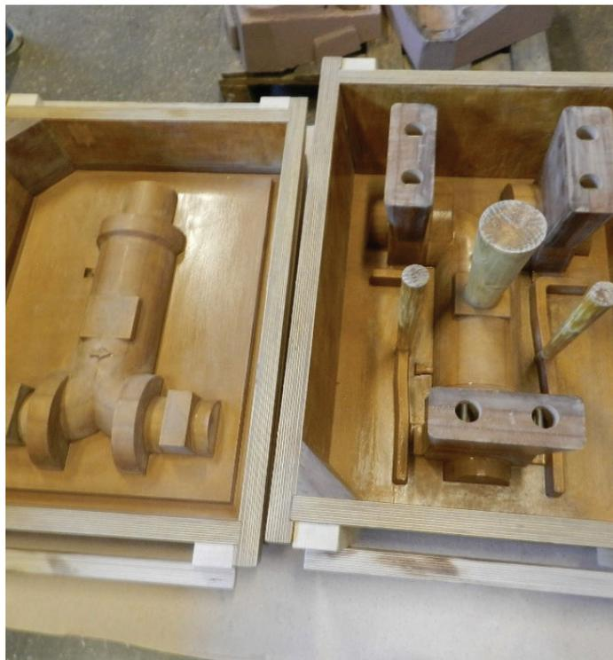
Рис. 2. Модельный комплект, выполненный из дерева
