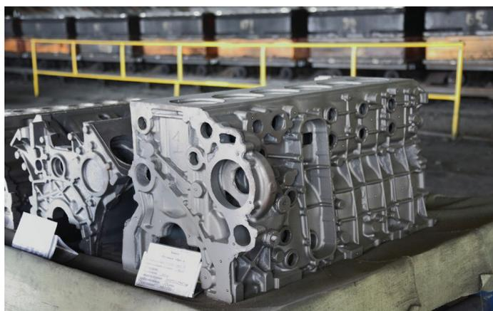
Рис. 1. Блок цилиндров двигателя
