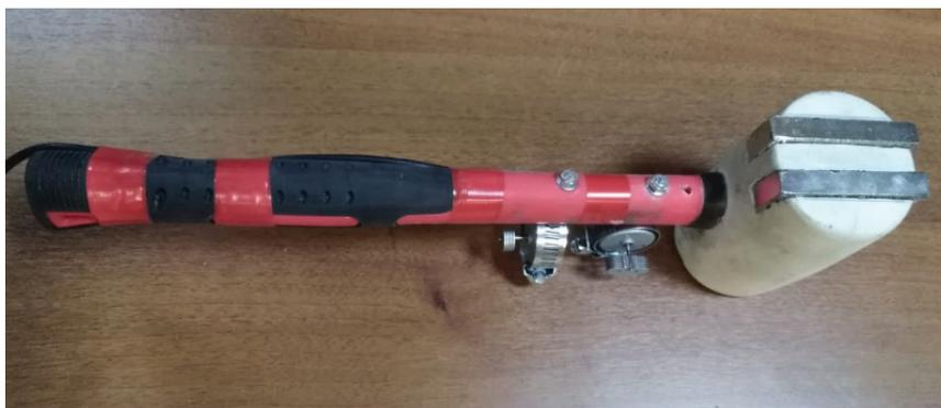
Рис. 2. Вибромолоток с неодимовыми магнитами
