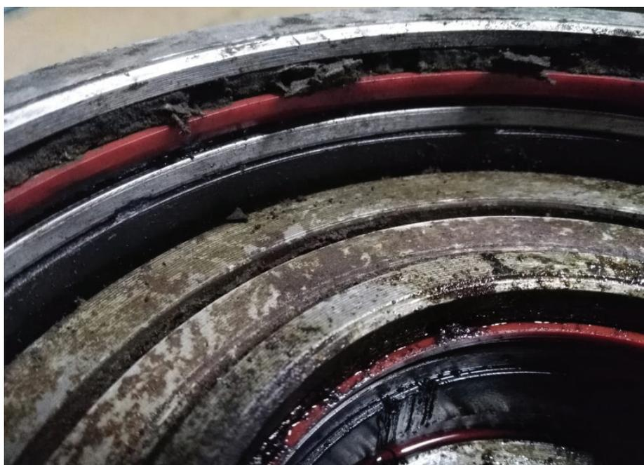
Рис. 1. Неисправный гидроцилиндр подъёма платформы с загрязнениями на манжетах
