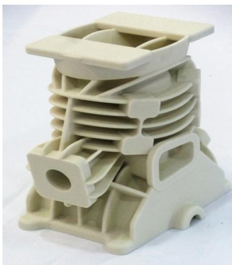
Рис. 3. 3D-модель из ABS пластика
