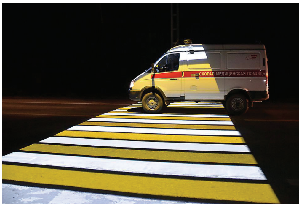
Рис. 4. Проекционная разметка хорошо заметна в тёмное время суток и при любой погоде
