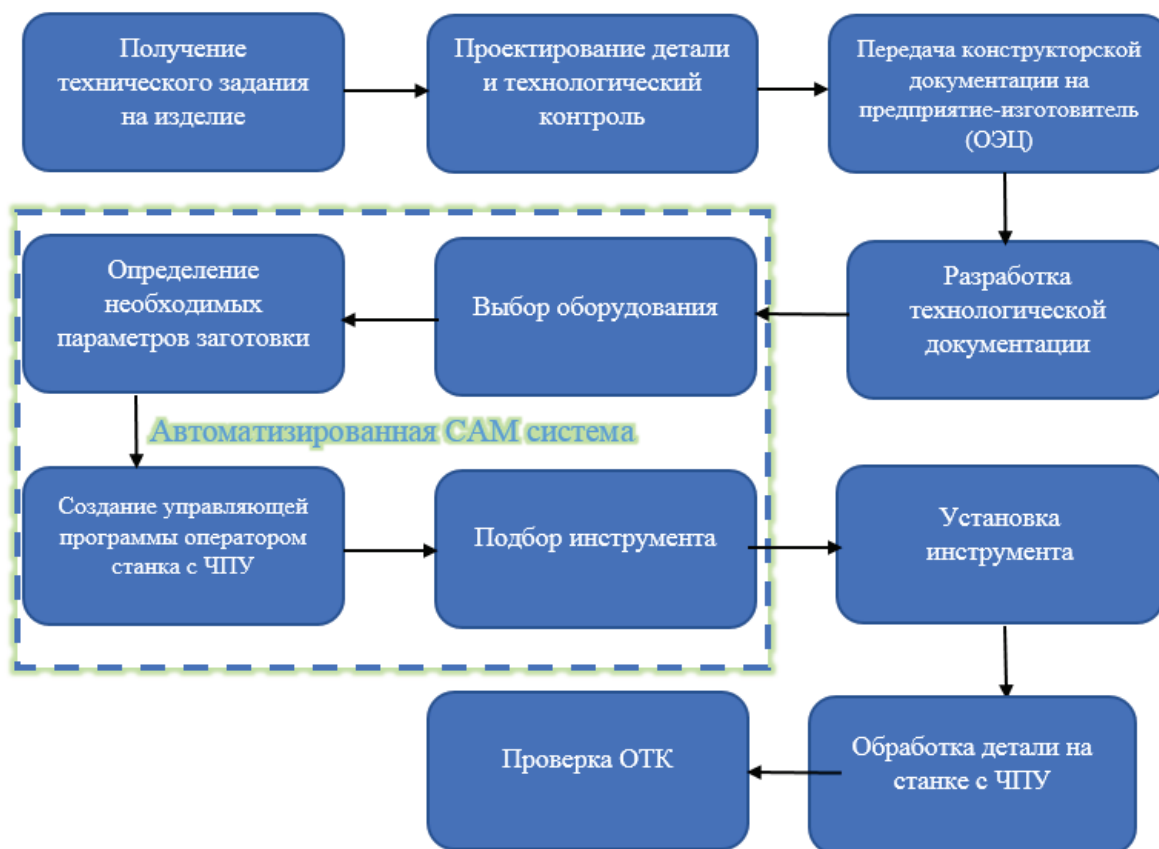
Рис. 2. Преобразованный жизненный цикл детали
