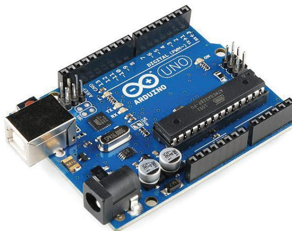
Рис. 3. Микроконтроллер Arduino Uno
