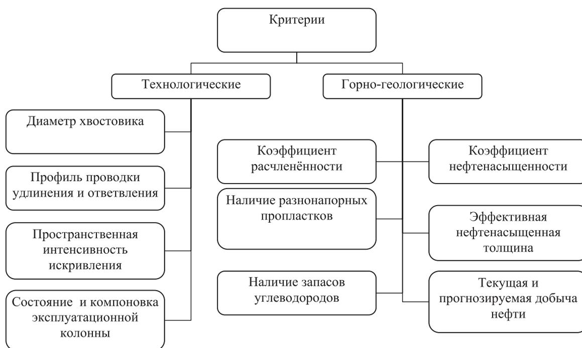
Рис. 1. Организационно-технологические критерии, учитываемые при разработке технологии бурения удлинений и ответвлений боковых стволов
