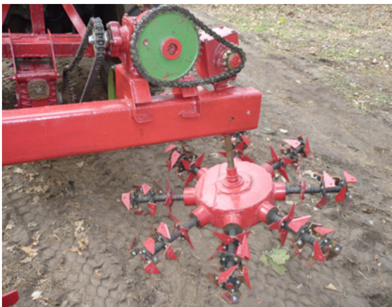
Рис.3. Экспериментальный образец ротационного рабочего органа
