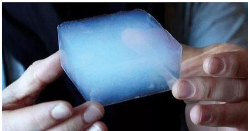
Рис. 1. Образец аэрогеля из диоксида кремния
