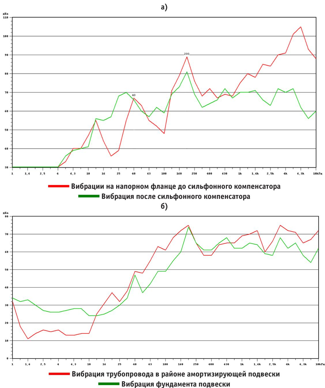
Рис. 3. 1/3 октавный спектр вибрации эффективности сильфонного компенсатора (а) и подвески трубопровода (б)
