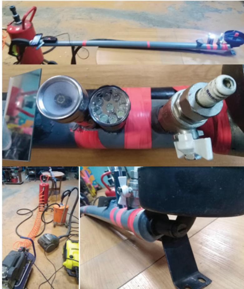
Рис. 1. Устройство для удаления коррозии и отслаивающейся краски с днища автомобилей
