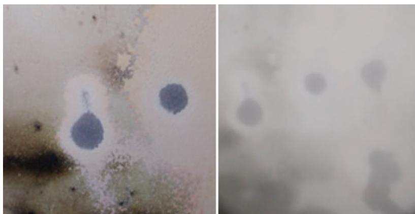
Рис. 2. Снижение чёткости изображения в результате повреждения стекла абразивными частицами
