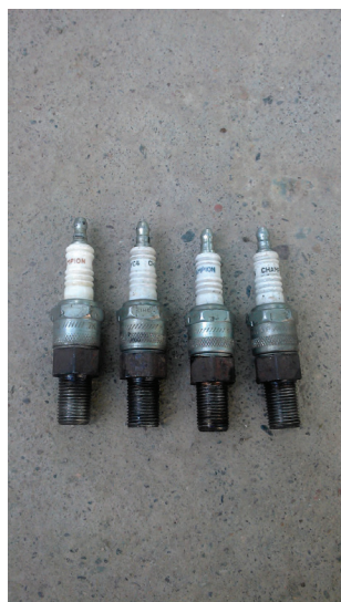
Рис. 4. Свечи зажигания и их подставки в сборе
