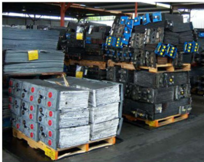
Рис. 1. Свинцовые батареи и пластины после разборки
