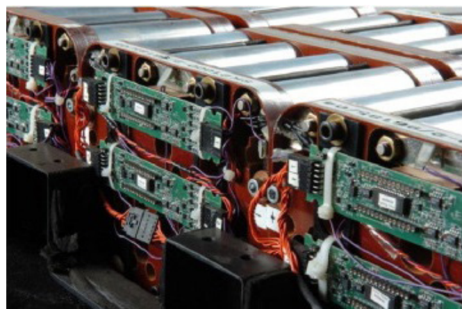
Рис. 2. Модульное подключение литий-ионный аккумуляторов
