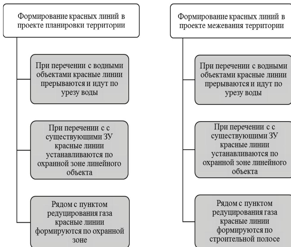
Рис. 1. Основные положения стандарта формирования красных линий в проекте планировки и межевании территории для размещения линейного объекта — газопровода
