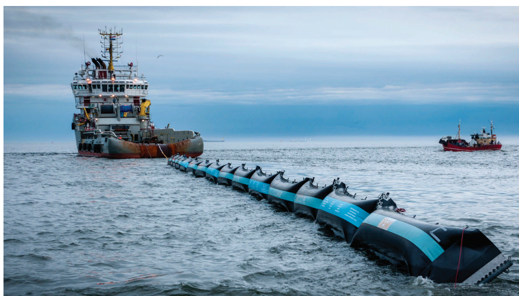
Рис. 4. Метод сбора мусора с помощью барьеров
