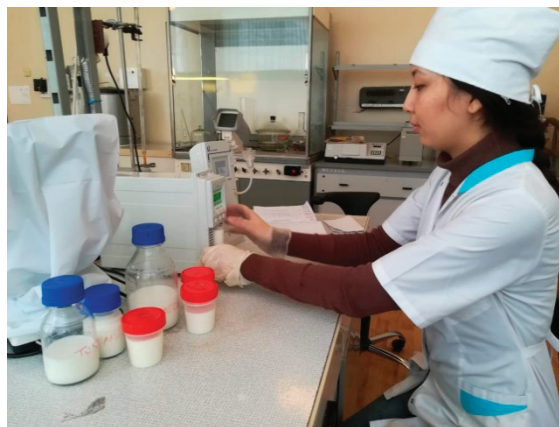
Рис. 2. Исследование физико-химических показателей молока на приборе Лактан 4
