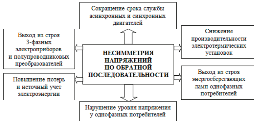
Рис. 2. Последствия воздействия несимметрии напряжений по обратной последовательности на элементы электрической сети
