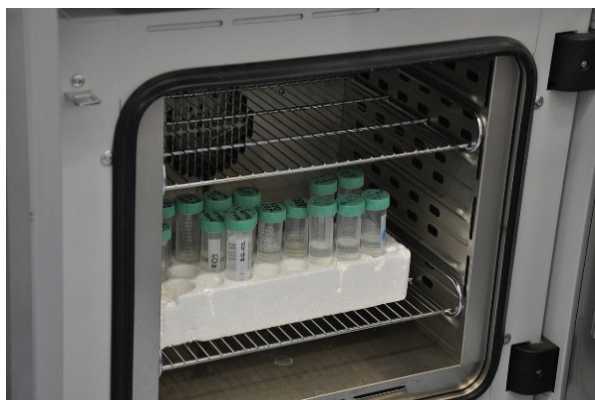
Рис. 5. Процесс дериватизации после добавления нитробензальдегида (составлено автором)
