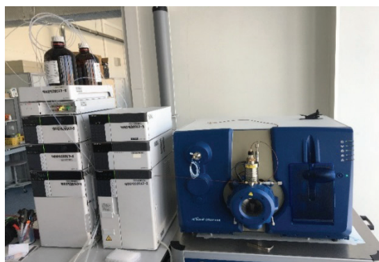
Рис. 9. ВЭЖХ-МС/МС в лаборатории доклинических исследований МФТИ (составлено автором)
