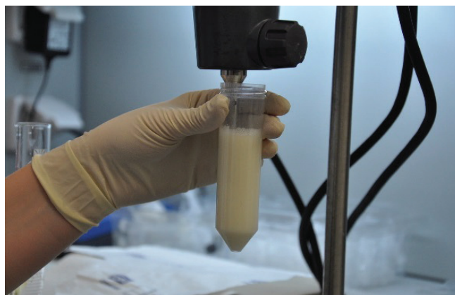
Рис. 3. Диспергирование водно-хлебной смеси (составлено автором)
