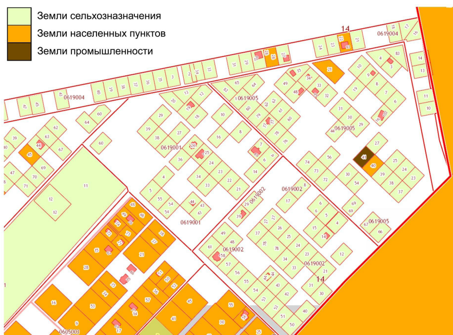
Рис. 1. Разные категории земель в рамках 1 кадастрового квартала на примере СНТ «Малое Карлино»
