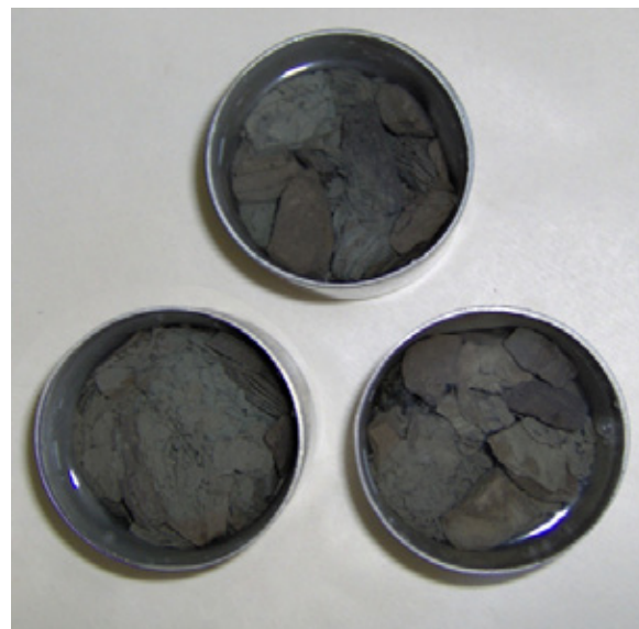
Рис. 2. Известняк после 6 циклов замораживания-оттаивания
