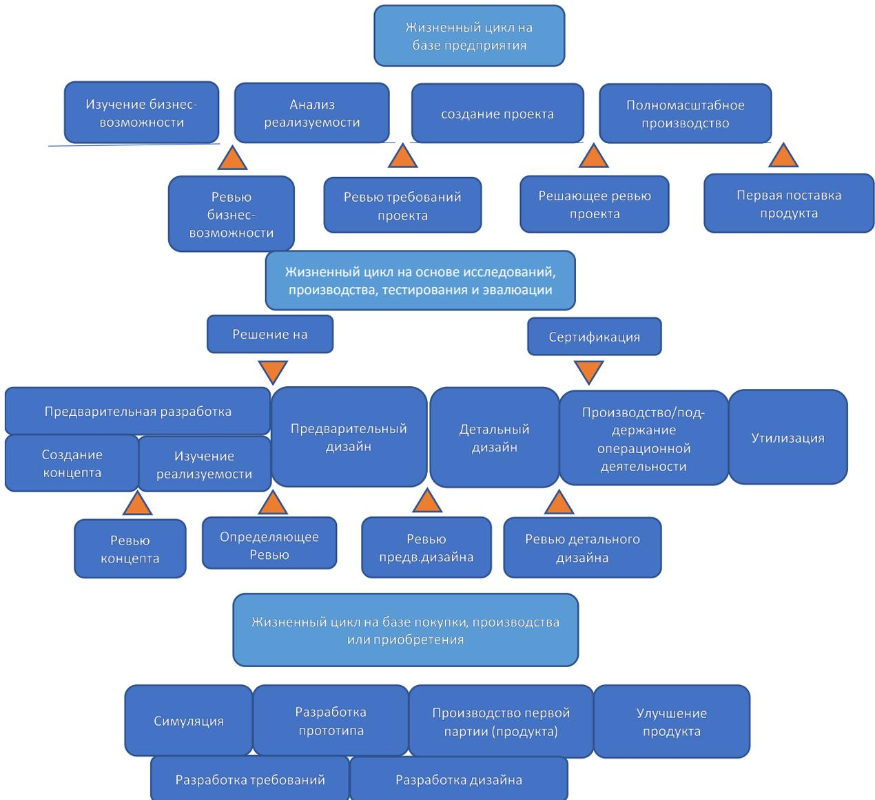
Рис. 1. Три типа жизненных циклов системы
