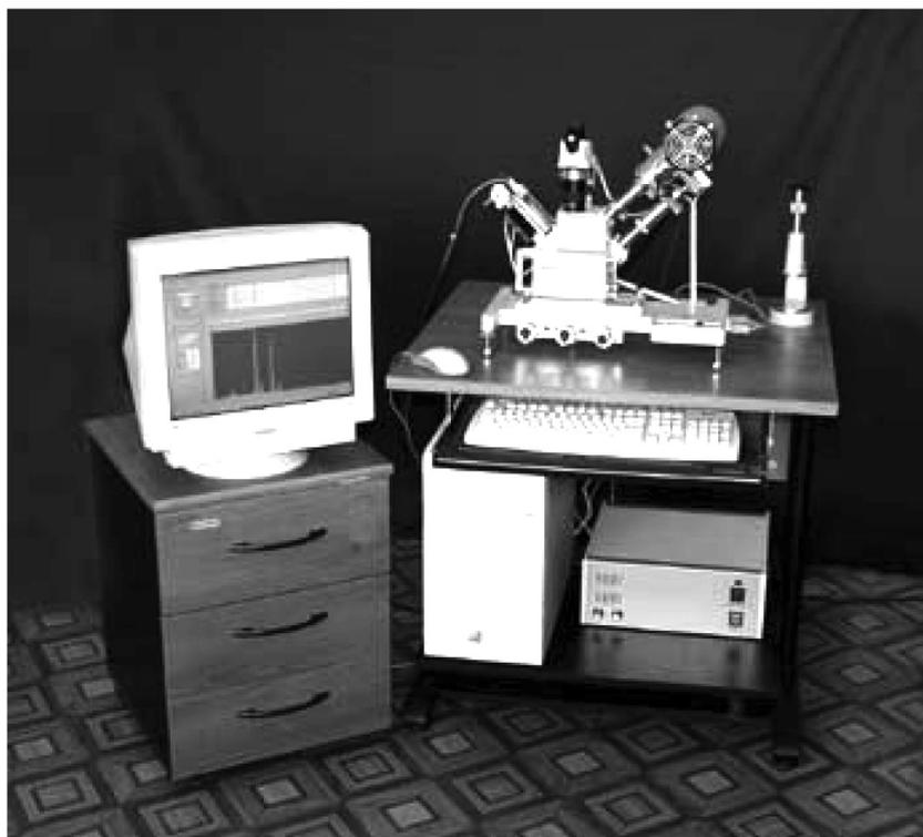
Рис. 1. Рентгенофлуоресцентный спектрометр Фокус М2 и ЭВМ
