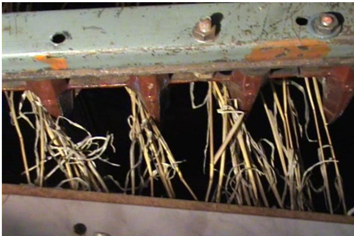
Рис. 6. Отгиб стеблей пальцами режущего аппарата, повернутого относительно направления движения жатвенного агрегата на угол \beta=25^\circ
