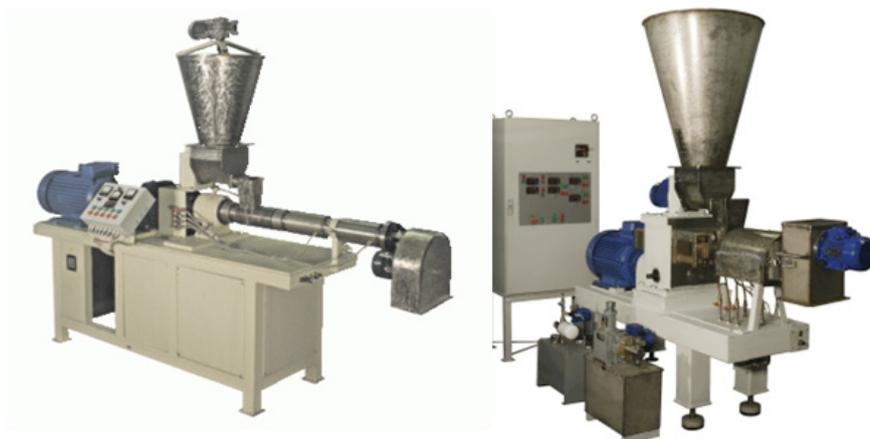
Рис. 2. Экструдер двухшнековый ШТАК-50М (справа) и ШТАК-80М (слева)
