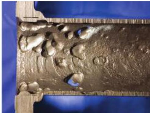
Рис. 1. Сероводородная коррозия
