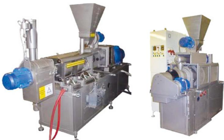
Рис. 3. Экструдер одношнековый ЭУИ-1 (слева) и двухшнековый ЭУИ-2 (справа)
