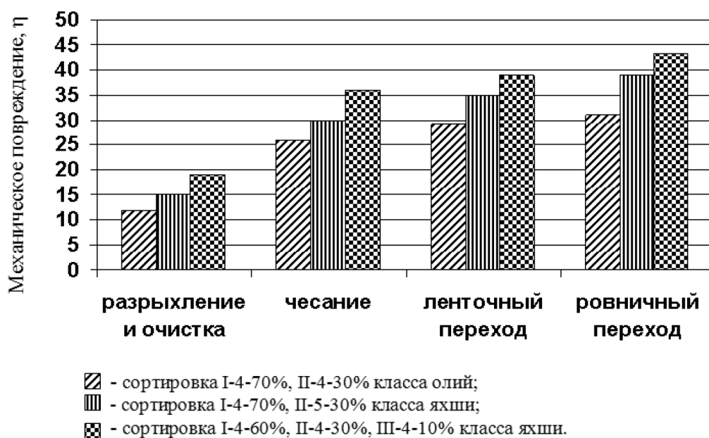
Рис. 1. Влияние типовой сортировки на механическое повреждение продуктов прядения
