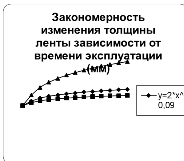
Рис.2. Закономерности изменения толщины транспортирующей ленты в зависимости от времени эксплуатации: ряд 1 — лента, изготовленная из суровой ткани; ряд 2 — лента, изготовленная из обработанной ткани; ряд 3 — лента, изготовленная из нетканого полотна
