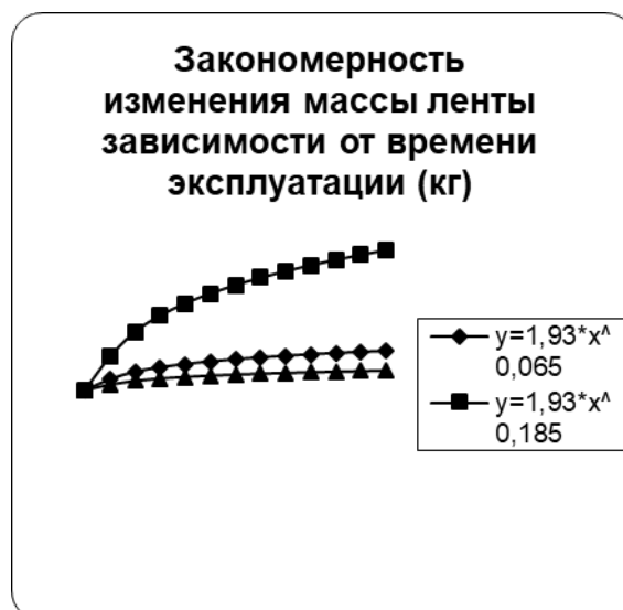
Рис. 1. Закономерности изменения массы транспортирующей ленты в зависимости от времени эксплуатации: ряд 1 — лента, изготовленная из суровой ткани; ряд 2 — лента, изготовленная из нетканого полотна; ряд 3 — лента, изготовленная из обработанной ткани
