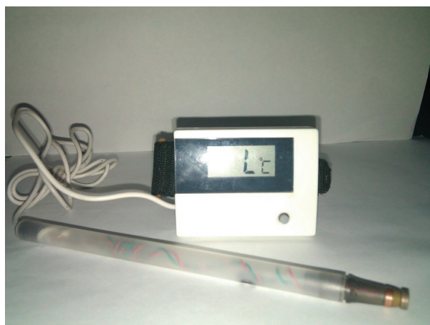
Рис. 5. Принципиальная схема (а), общий вид (б) и способ использования (в) амперометрического датчика для определения суммарной АОА
