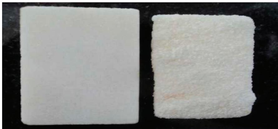
Рис. 1. Осаждение вторичного осадка при нейтрализации БСКС (слева пластинка до нейтрализации, справа — пластинка после нейтрализации)
