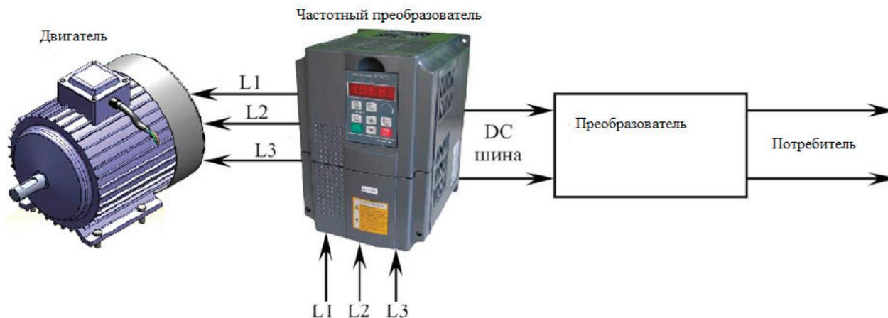
Рис. 5. Блок-схема предлагаемого устройства рекуперации энергии
