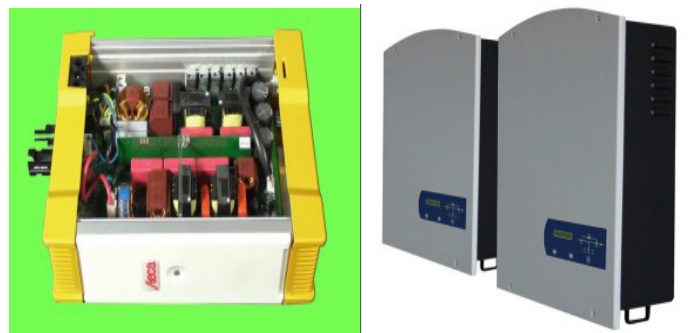
Рис. 3. А) Сетевой инвертор [2], Б) Автономный инвертор
