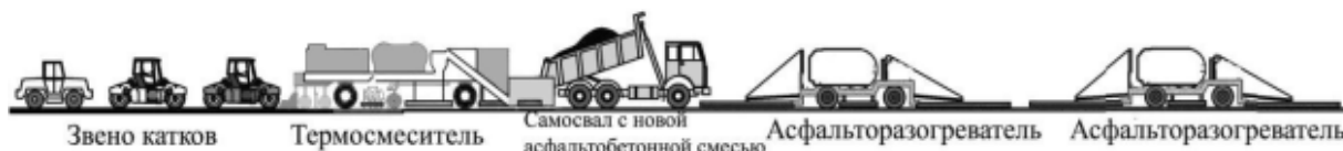
Рис. 3. Схема расположения машин в технологическом потоке
