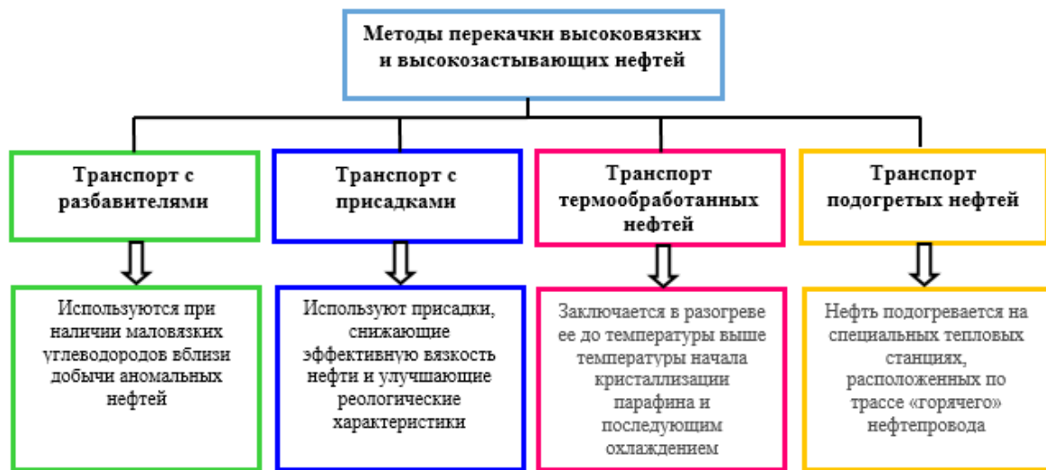
Рис. 1. Классификация методов перекачки высоковязкой нефти
