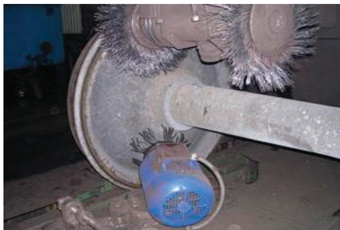
Рис. 2. Установка для сухой очистки осей колесной пары
