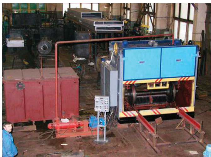
Рис. 3. Общий вид автоматизированного комплекса для очистки колесных пар
