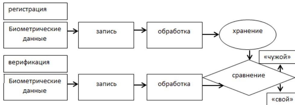
Рис. 1. Упрощенная архитектура биометрической системы обнаружения подмены законного оператора
