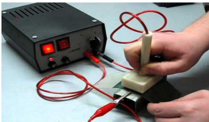
Рис. 3. Электрохимическая маркировка с наложенным диэлектрическим трафаретом
