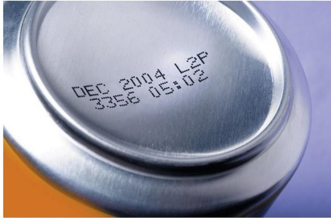
Рис. 4. Каплеструйная маркировка
