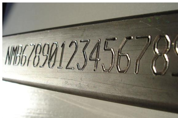
Рис. 7. Маркировка прочерчиванием
