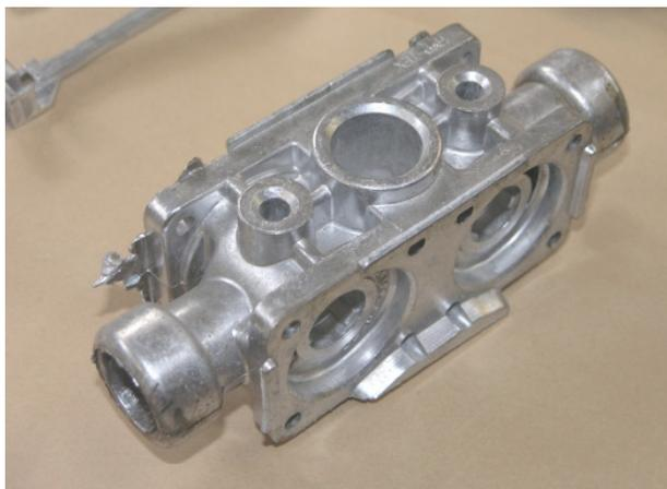
Рис. 1. Деталь из сплава 1201
