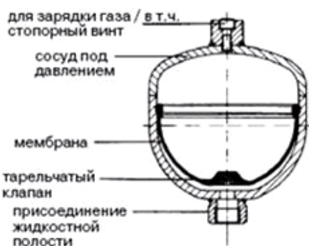
Рисунок 3. Вариант конструктивного исполнения гидравлического аккумулятора типа “мембрана”
