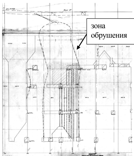
Рис. 1.4 Развитие зоны обрушения на подземном руднике Гайского месторождения
