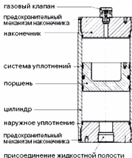
Рисунок 2. Вариант конструктивного исполнения поршневого гидравлического аккумулятора
