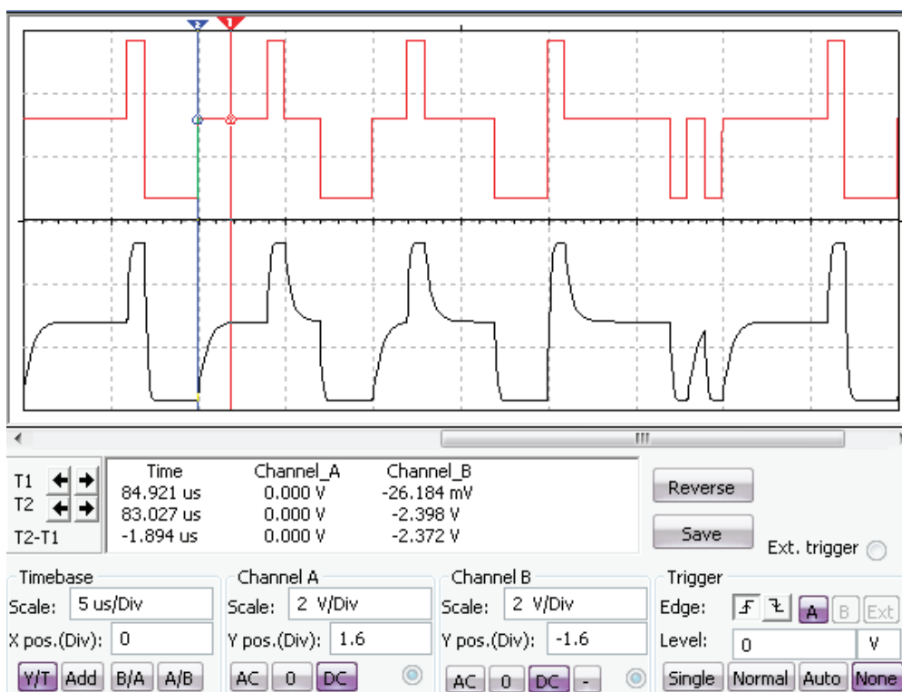
Рис. 9. Результаты тестов инвертора (красный — входной сигнал, черный — выходной)
