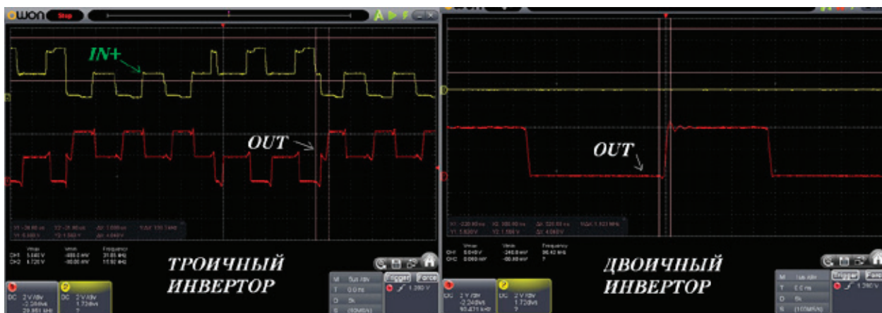
Рис. 13. Выходные сигналы троичного (слева) и двоичного (справа) инверторов на IRF9952PBF
