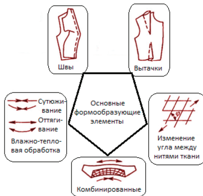
Рис.1. Основные формообразующие элементы при проектировании конструкции одежды
