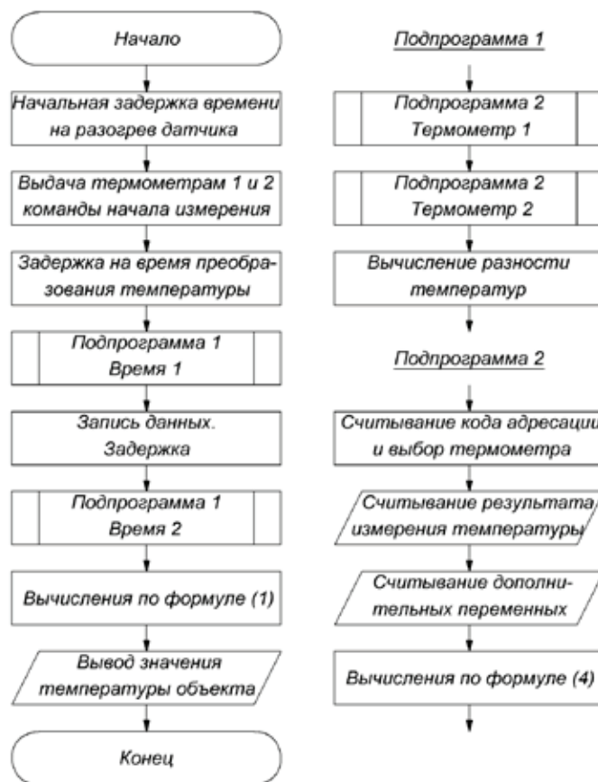
Рис. 4. Блок-схема алгоритма обработки сигналов датчиков
